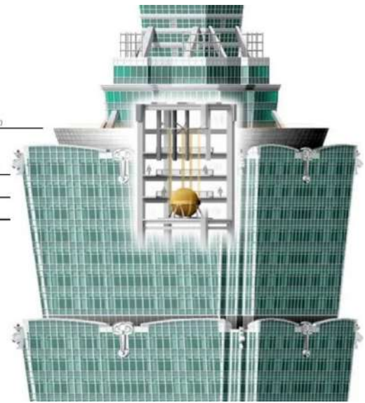
Figuras 107 e 108 | Localização e esquema do TMD do Taipei 101
