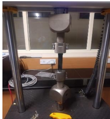
Fig. 9 - UTM (BISS- Instron) - tensile test
