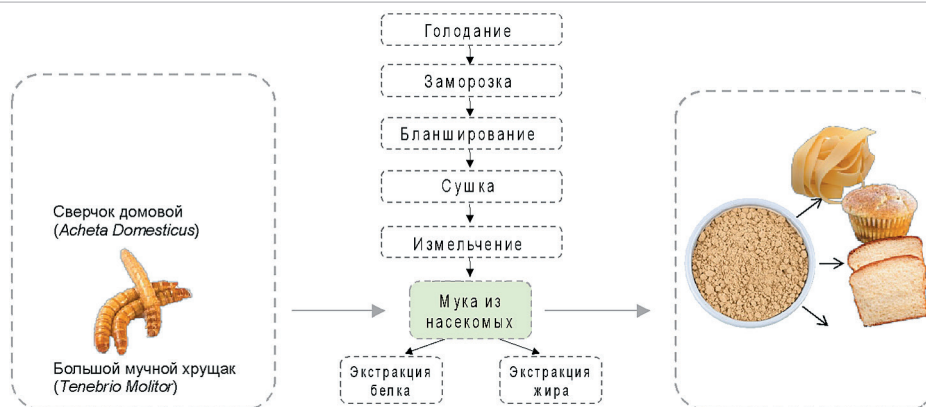
Рисунок 2. Принципиальная блок-схема процесса обработки энтомологической биомассы Figure 2. Basic block diagram of processing entomological biomass
