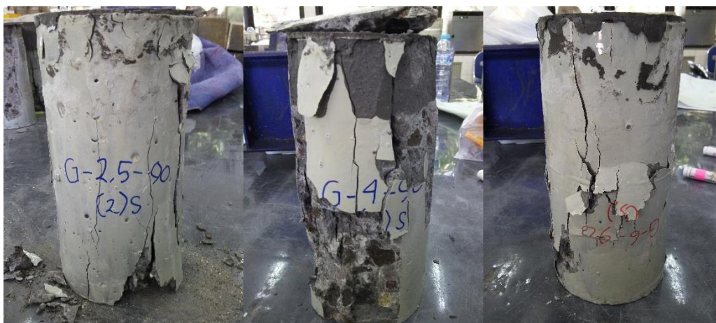
Gambar 7. Spesimen Tipe A, B dan C yang Telah Diuji Kuat Tekan
