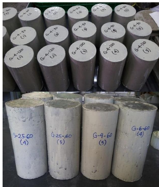
Gambar 3. Spesimen yang Direndam pada Seawater Curing Dilapisi dengan Epoxy Resin
