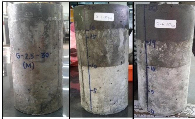
Gambar 2. Visualisasi Mortar Geopolimer yang Melapisi Beton
