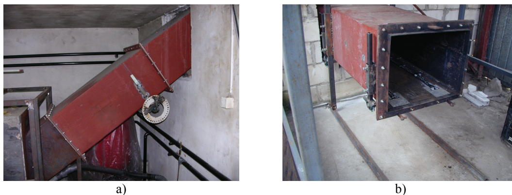
Slika 3. Kosi (a) i horizontalni (b) uvodnik bala
