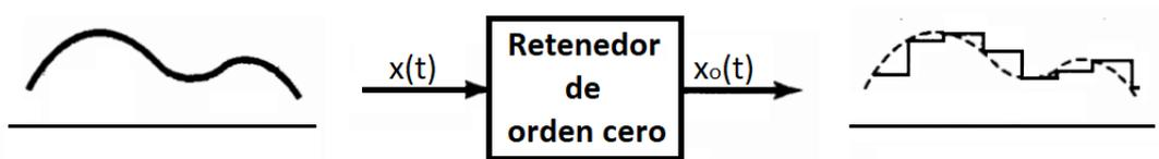
**Figura 2.20.** Muestreo mediante retenedor de orden cero.
