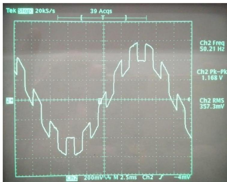
**Figura 3.74.** Señal de entrada INP para una masa de 1Kg y ruido seno de 50Hz.
