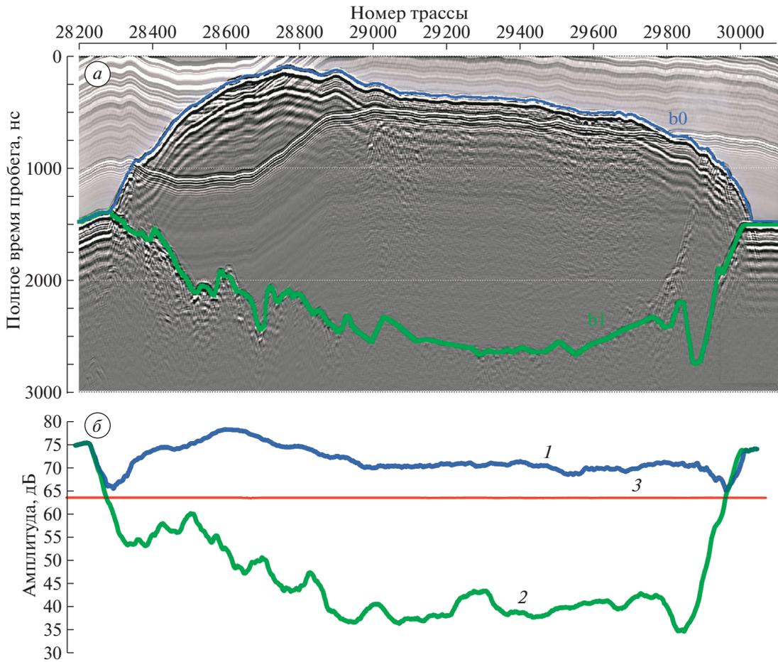
**Рис. 1.** Пример радарной записи 035\_014\_10 с отпикерованными отражениями от поверхности (b0) и ложа (b1) ледника (a) и осредненные по 50 трассам амплитуды этих отражений (б) от поверхности (1) и ложа (2). Линия (3) показывает амплитуду зондирующего импульса.
