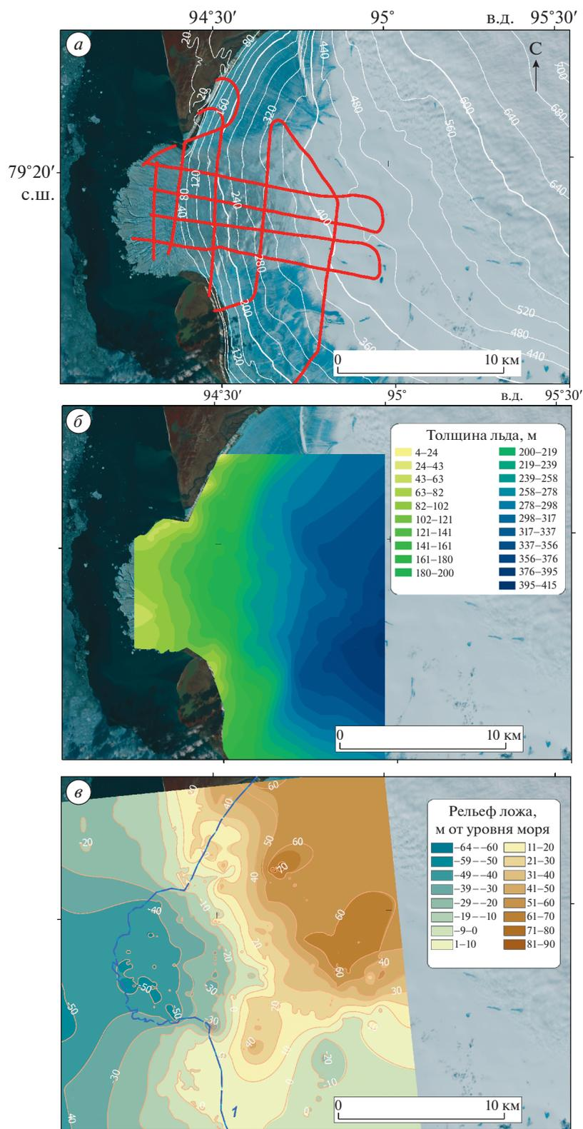
**Рис. 2.** Положение профилей аэrorадиозондирования в западной части ледникового купола Вавилова (а), картосхемы толщины льда (б) и подледного рельефа (в) по этим данным. Для карты подледного рельефа использовались также данные батиметрии у фронта ледника. Линия (I) показывает положение края ледникового купола в августе 2014 г.
