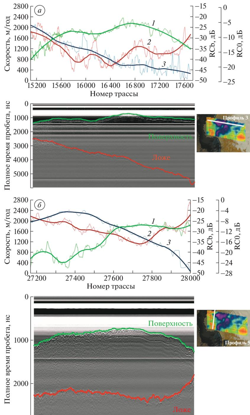
**Рис. 6.** Коэффициент отражения от поверхности (1) и ложа (2) ледника и поверхностная скорость движения ледника (3) на продольном (а) и поперечном (б) профилях по данным аэрорадиозондирования 15 сентября 2014 г. и снимкам Landsat-7 от 10, 12 и 28 августа 2014 г.
