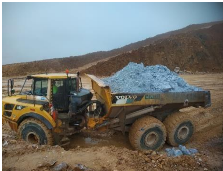
Gambar 5. Pengisian Vessel Truck Berlebihan ( Sumber: Data Primer di Lapangan, 2022 )
