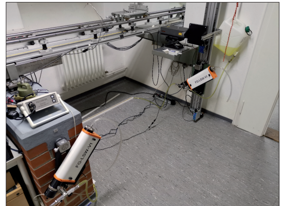
Abb. 15: Laboraufbau für automatisierte Höhenreferenzmessung der TU Dresden
