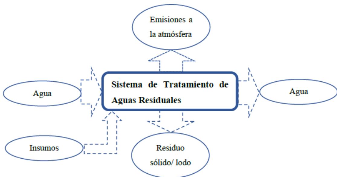
Figura 4 - Esquema conceptual de un sistema de tratamiento de aguas residuales.
