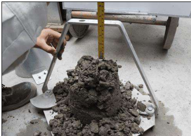
Figura 11: Slump en laboratorio.
