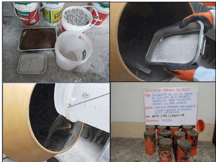
Figura 8: Preparación del concreto con ceniza de eucalipto.
