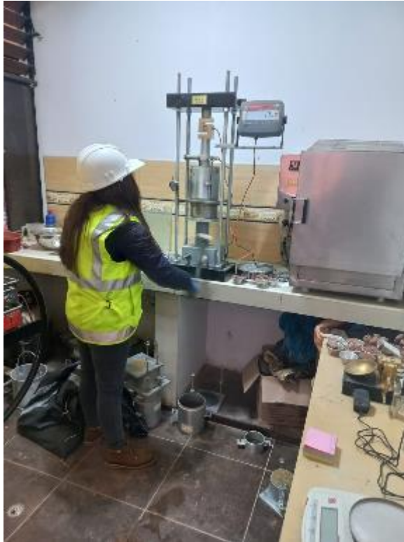
Fotografía 09: Ejecución del ensayo de C.B.R, según norma ASTM D 1883 y el MTC E 132.
