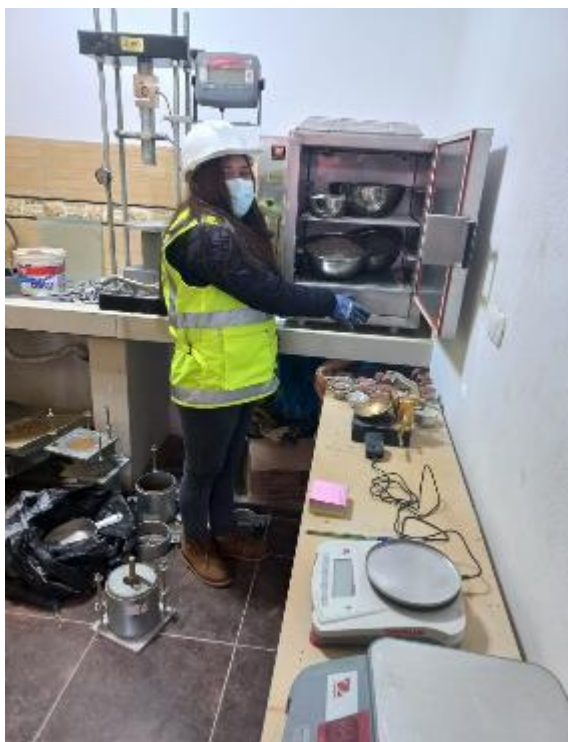
Fotografía 05: En la imagen se ve el proceso de ensayo del contenido de humedad de los suelos (muestras extraídas de la cantera A, cantera B y cantera C), según norma ASTM D 2216.
