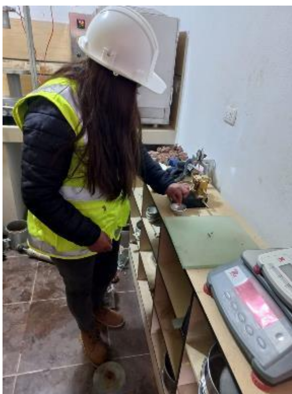
Fotografía 06: Proceso de ensayo de límite plástico de un tipo de suelo arenoso, según norma NTP 339.129 y MTC E 111.
