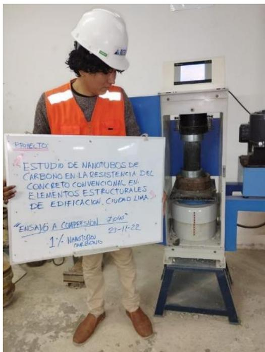
Ensayo a la compresión concreto convencional con 1% NTC.
