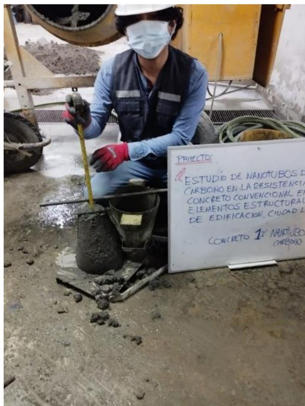
Medición de Slump concreto convencional con 1% NTC
