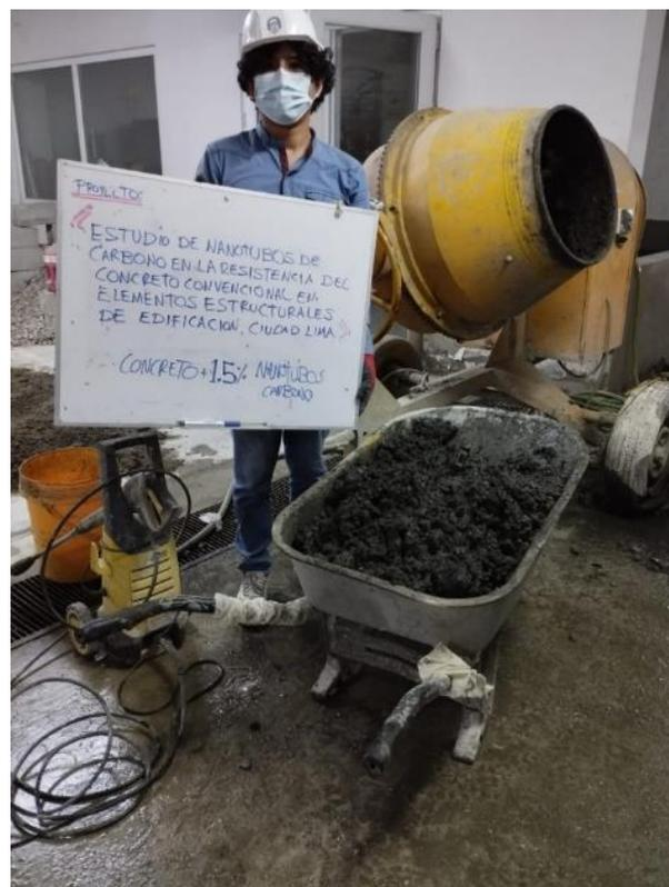
Diseño de mezcla concreto convencional con 1.5% NTC
