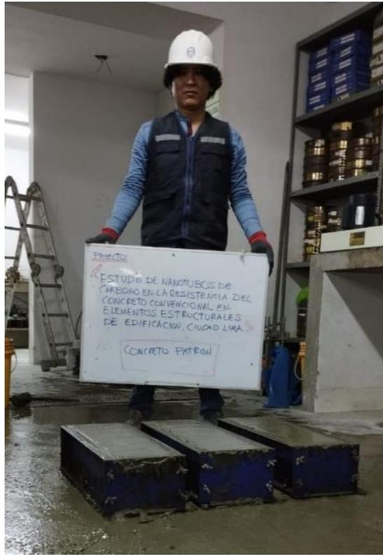
Vigas de concreto convencional para ensayo a flexion
