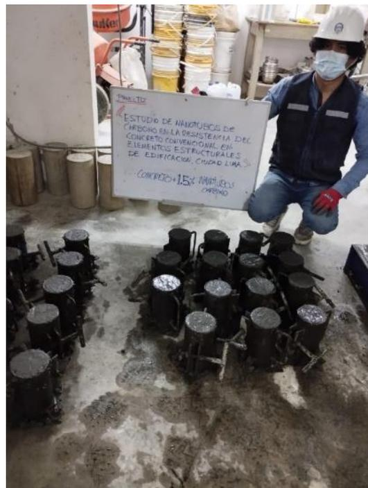
Especímenes para ensayo a compresión
