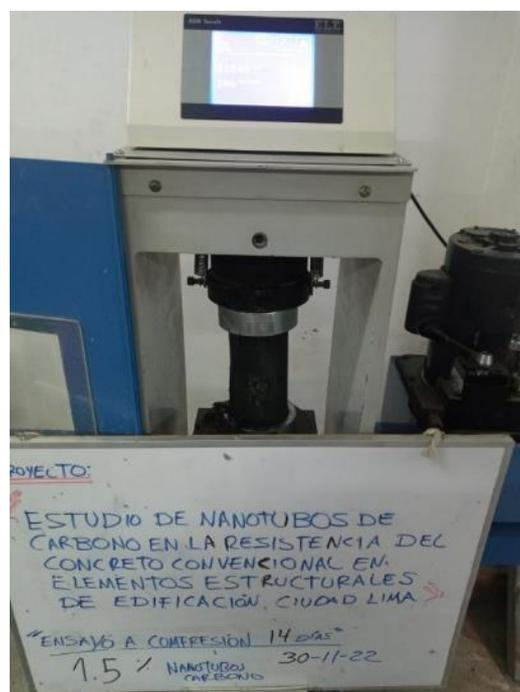
Ensayo a la compresión concreto convencional con 1.5% NTC.
