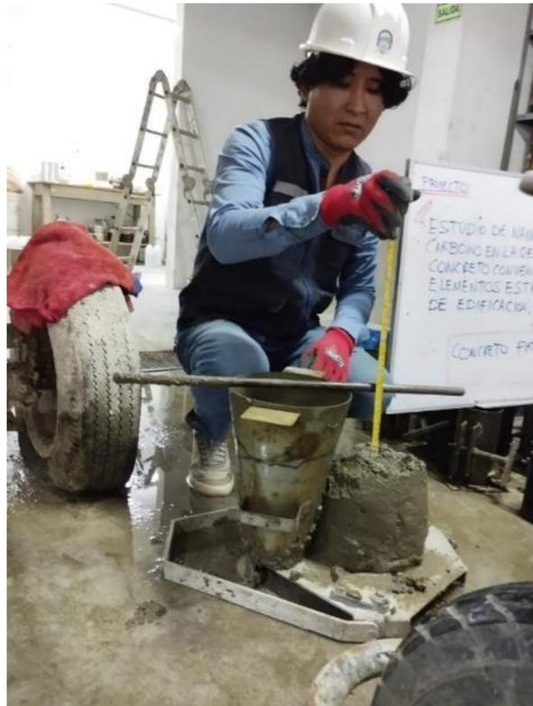
Medición de Slump concreto convencional
