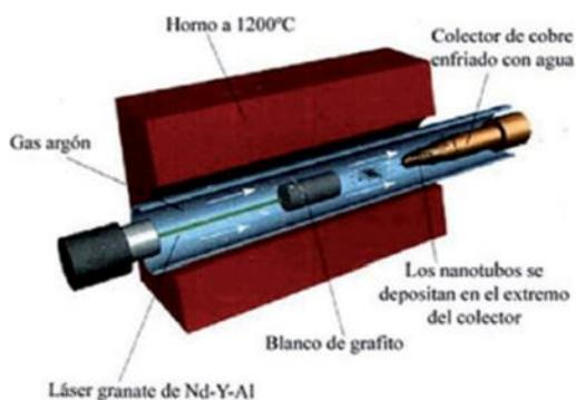
Figura N° 2. 5 Esquema del equipo por ablación láser
