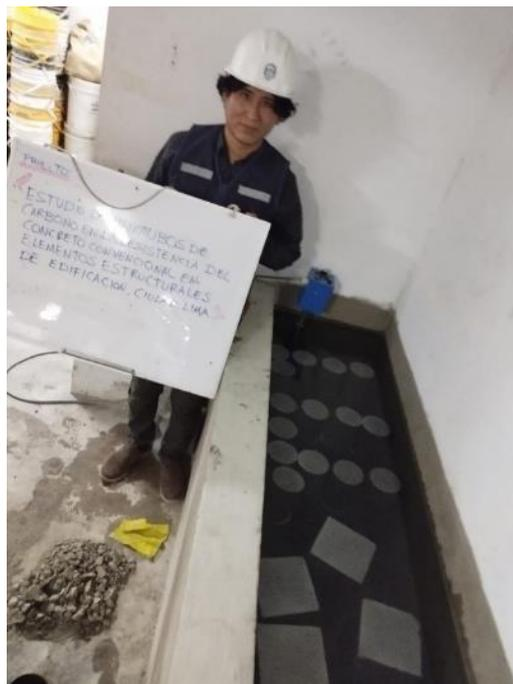
Poso de curado con control de temperatura automático
