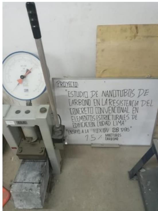
Ensayo de flexión a concreto convencional con 1.5% NTC
