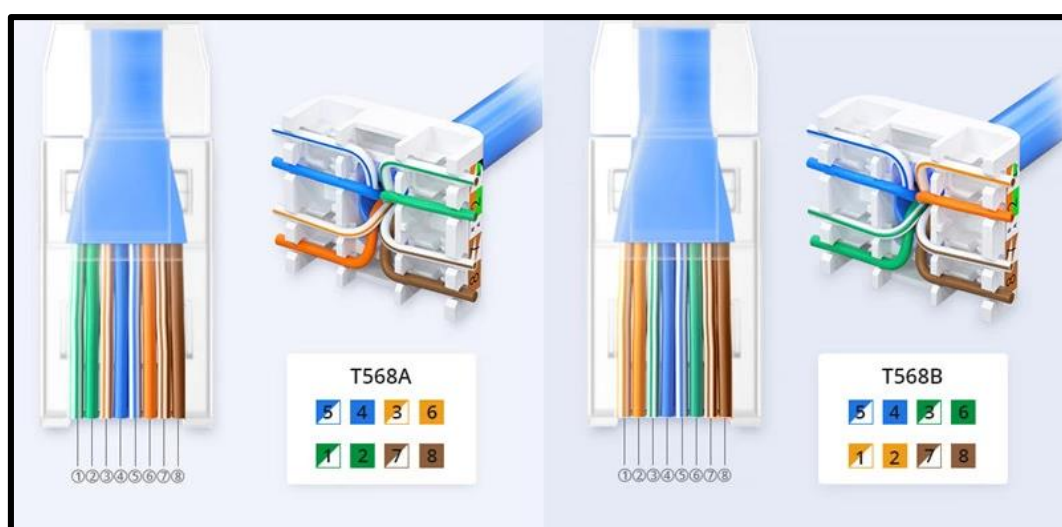
Figura 4.10: Estándares de cableado T568A-T568B
