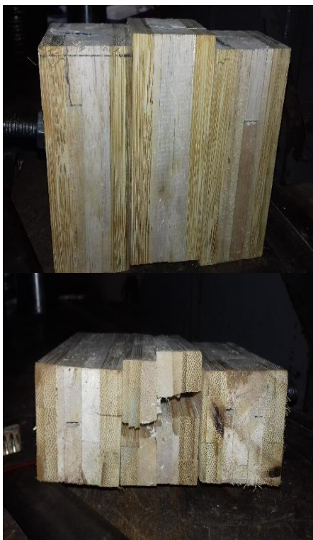
Gambar-7. Kerusakan benda uji tahanan lateral.
