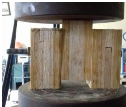
Gambar-3. Setting pengujian sambungan lateral.
