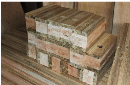
Gambar-2. Batang komposit kayu-bambu laminasi.
