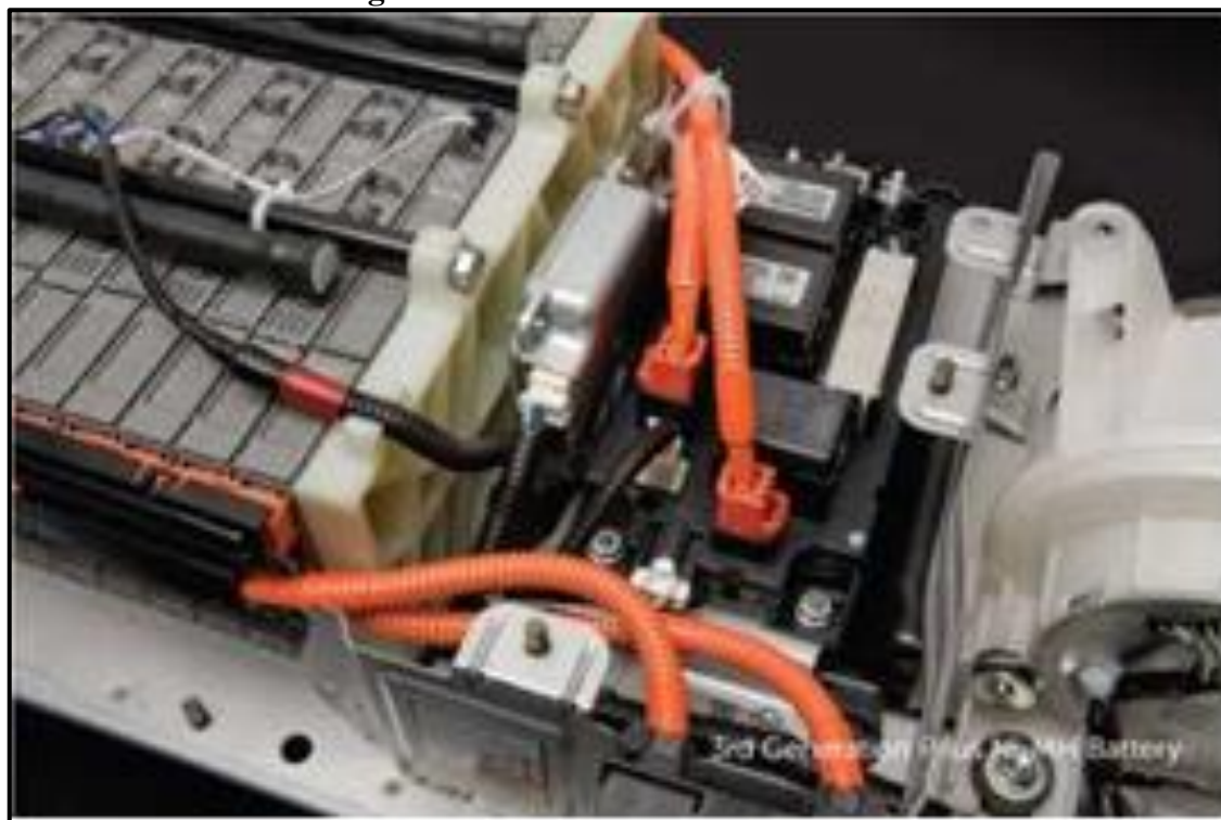
Figura N° 2.11: Baterías de Alta Tensión
