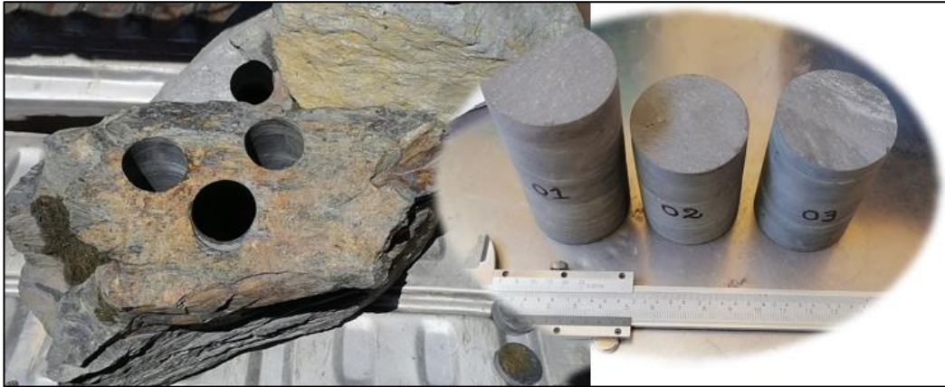
Fotografía N° 6 testigo de roca pizarra del macizo rocoso agosto 2021.
