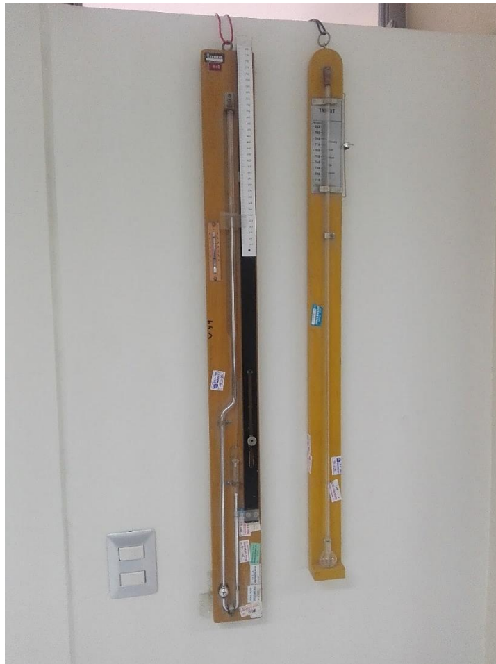
Figura 3.9: Barómetro (Laboratorio de Física – UNA)
