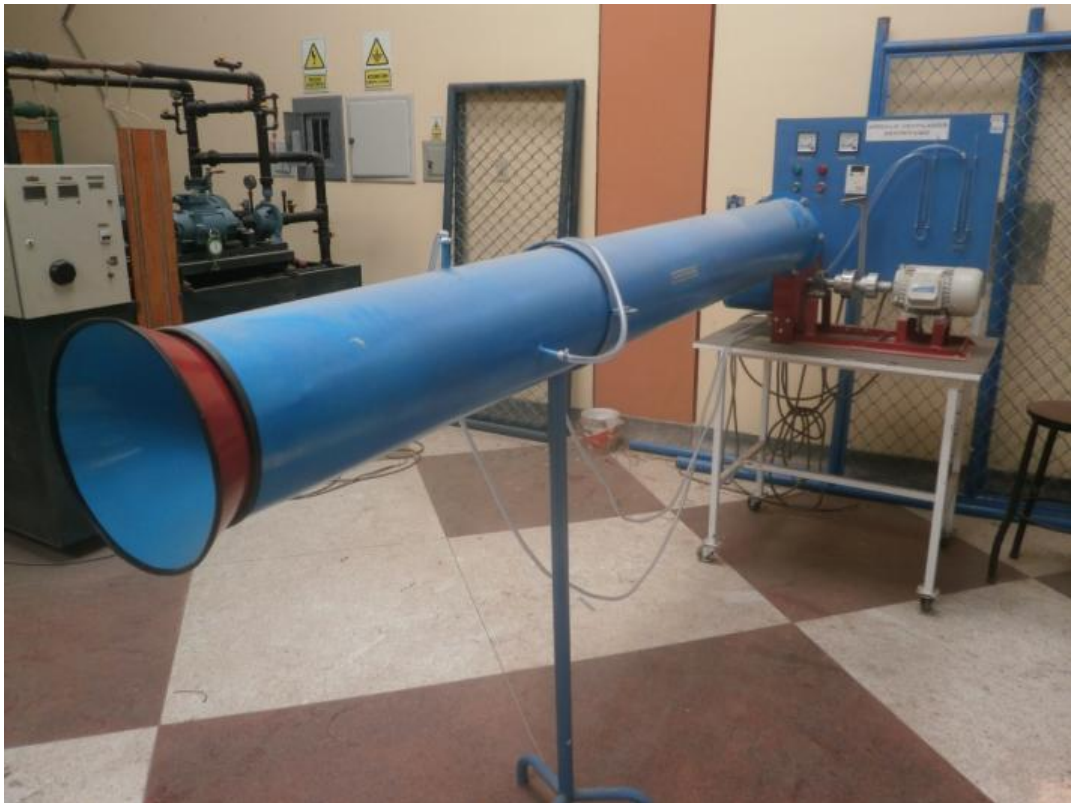
Figura 3.12: Módulo de ensayo de ventilador centrífugo tipo B.
