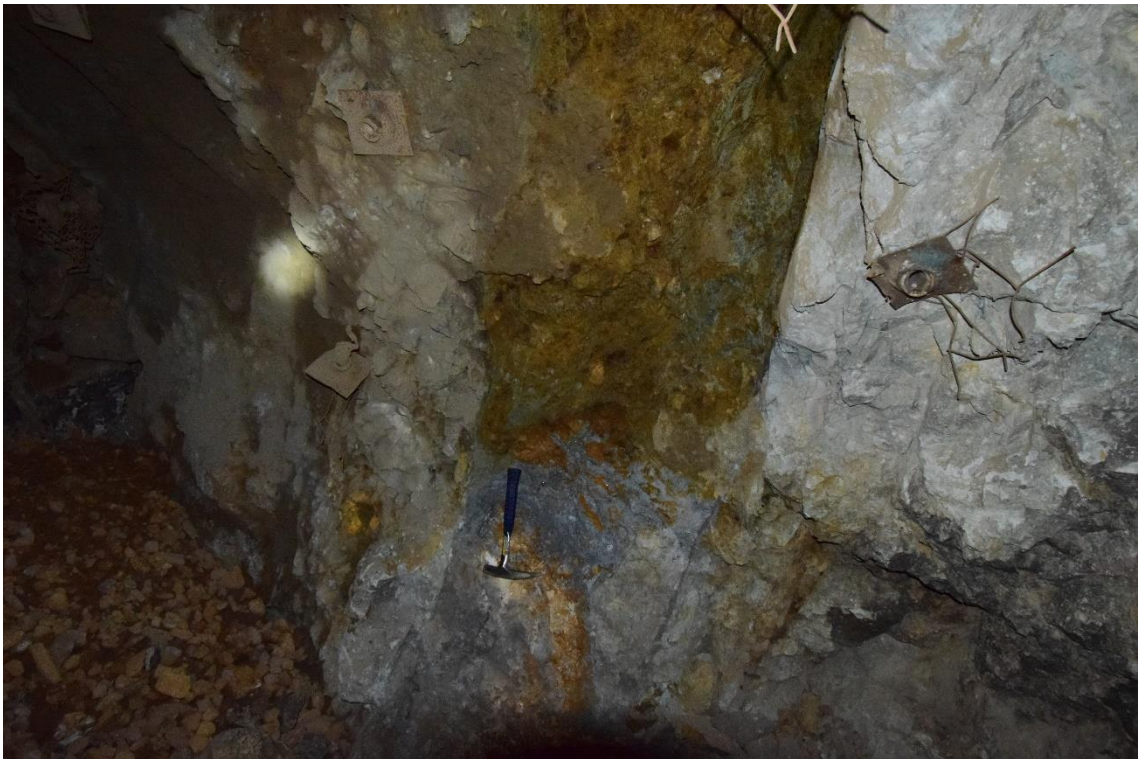
Figura 4: Mineralización de la veta Zorro Rojo, Galería 190 NW Nv. 3240. Se puede apreciar la calidad del macizo rocoso mala A (IV-A).
