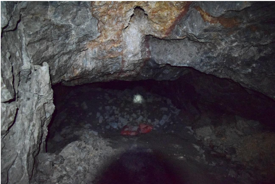
Figura 2: Galería 218 SE Nv. 3285, tajo explotado relleno.
