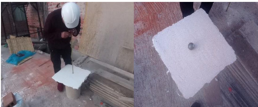
a) Medición de altura de impacto.
