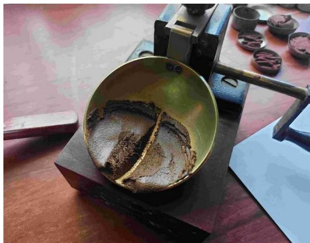
**Figura 37:** Cuchara Casagrande con muestra acanalada.
