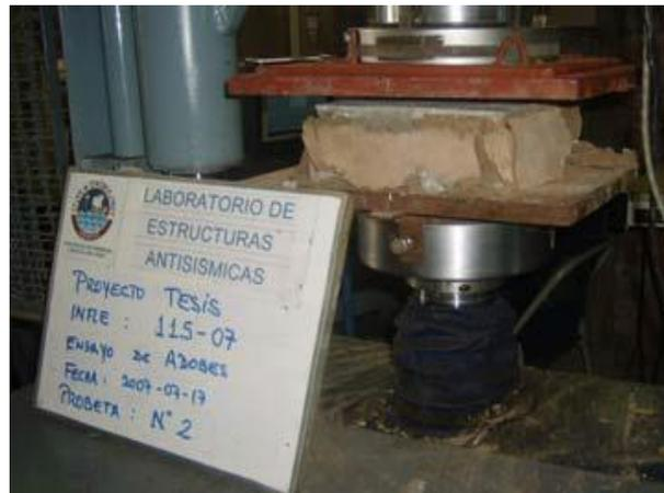
**Figura 18:** Ensayo de resistencia a la compresión.
