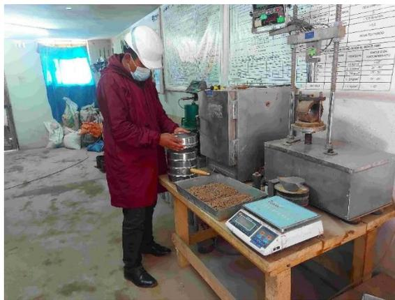
**Figura 33:** Ensayo de granulometría mediante tamizaje.
