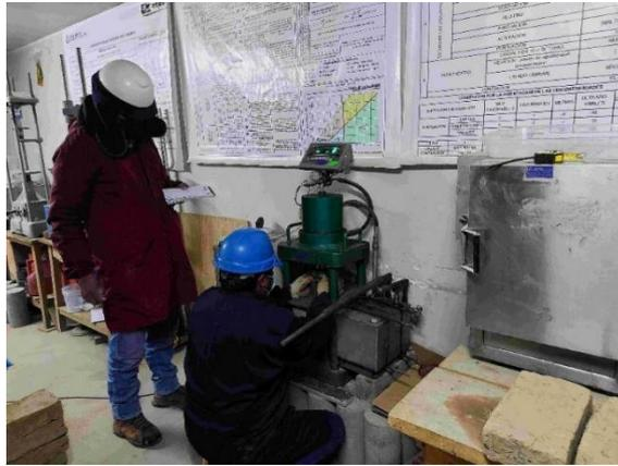
**Figura 45:** Colocación del bloque al equipo de compresión.
