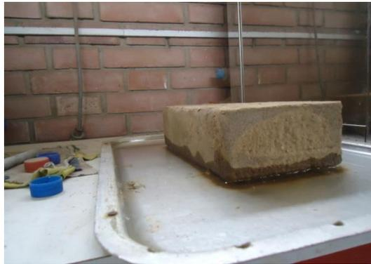
**Figura 15:** Especimen sometido al ensayo de succión
