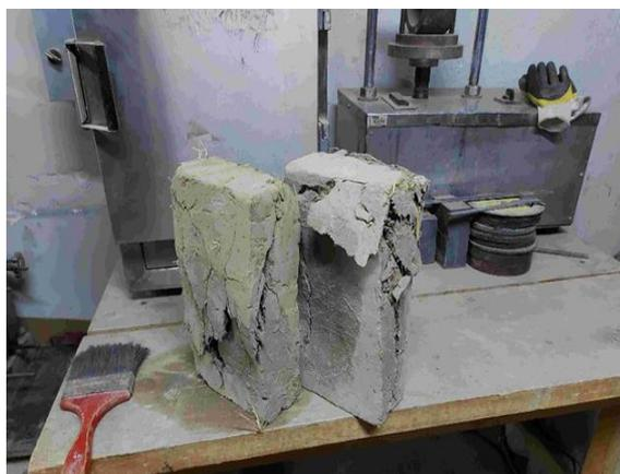
**Figura 47:** Falla de los bloques sometidos a compresión.
