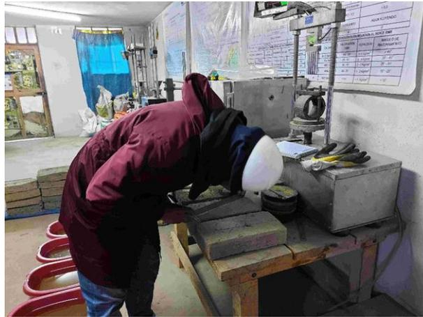
**Figura 39:** Medición de la concavidad de las unidades.
