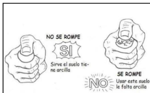
**Figura 9:** Prueba de la resistencia seca
