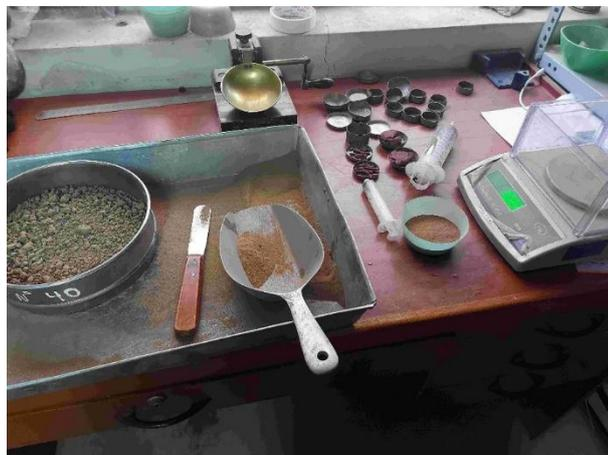
**Figura 34:** Equipo y materiales para realizar el ensayo de límite líquido.
