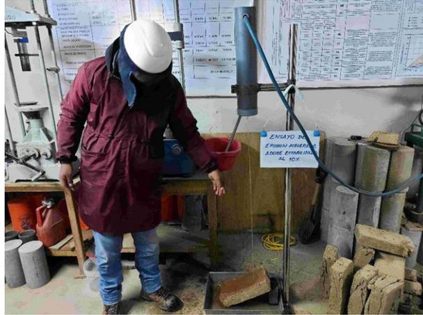
**Figura 44:** Ensayo de erosión acelerada de Swinburne (SAET).
