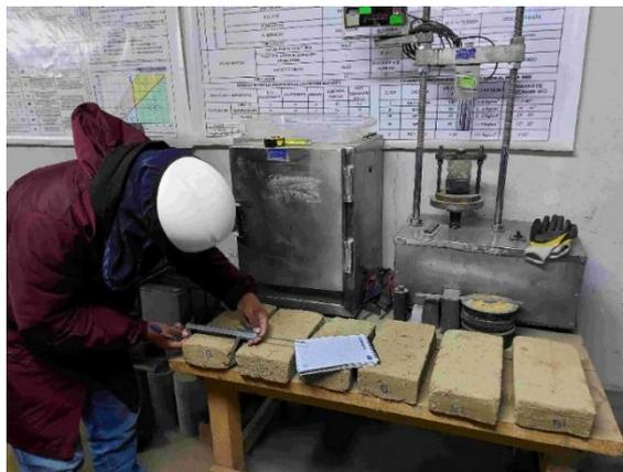
**Figura 38:** Medición de las dimensiones.
