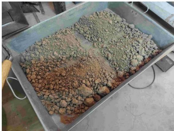
**Figura 32:** Cuarteo de muestra - Obtención de muestra representativa.
