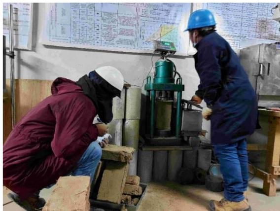
**Figura 46:** Sometimiento del testigo a fuerza de compresión.
