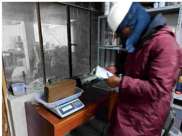
**Figura 43:** Registro de peso de muestra saturada Ensayo de absorción.
