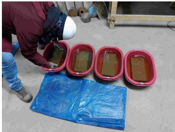
**Figura 42:** Especímenes sumergidos en agua durante 24 horas.
