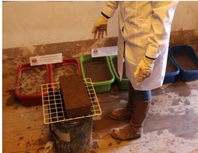
**Figura 16:** Especímenes sometidos a Ensayo de absorción
