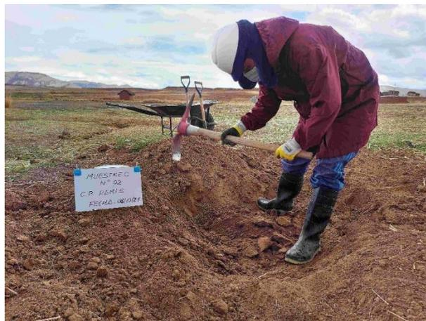
**Figura 21:** Muestreo de suelo - acopio de suelo.
