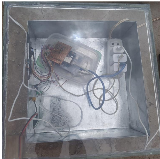
Figura B.2. Módulo de adquisición de datos con resistencia externa.
