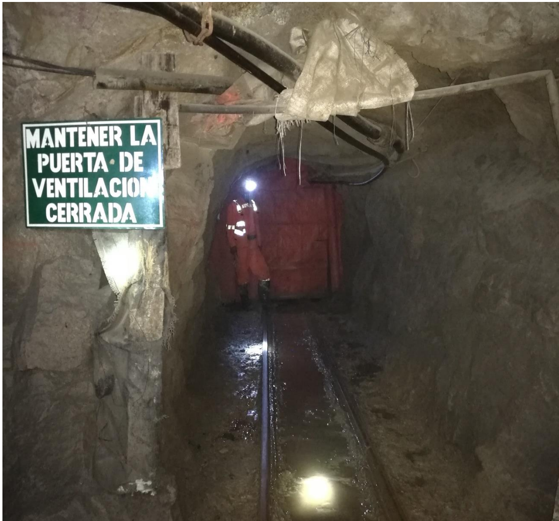
Figura 52: Puerta de ventilación utilizada para separar el circuito 1 y 2.
