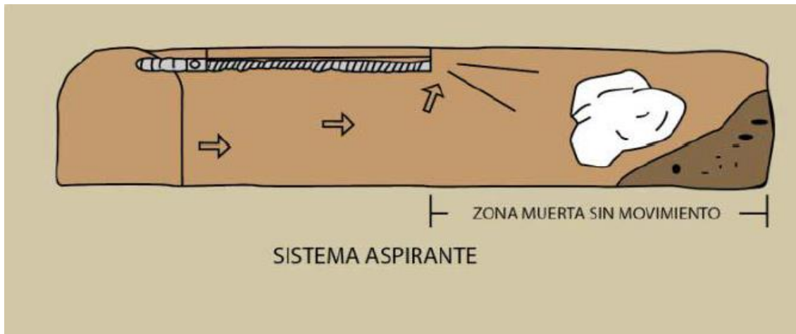
Figura 6: Ventilación auxiliar en modo aspirante o succionando.
