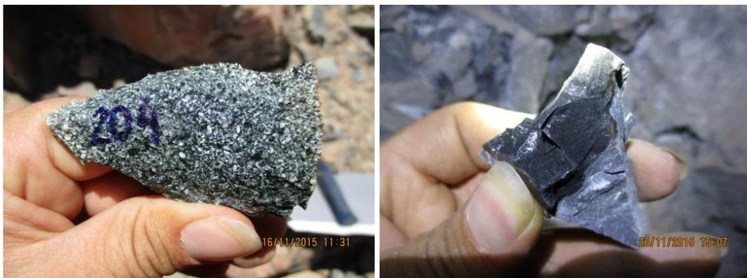
**Figura 6:** Andesita porfirítica y andesita afánítica de la Formación Guaneros.
