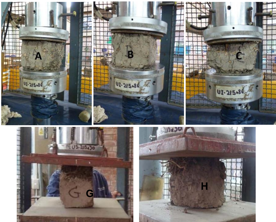
Figura 45. Ensayos a compresión de las probetas seleccionadas en la PUCP.
