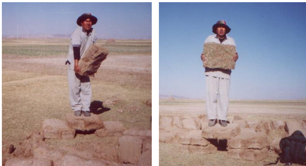
Figura 58. Ensayo de cargas para determinar resistencia a la flexión in situ.
