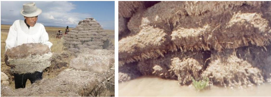
Figura 69. Vista del entrelazado de las raíces entre bloques de Ch'ampa.
