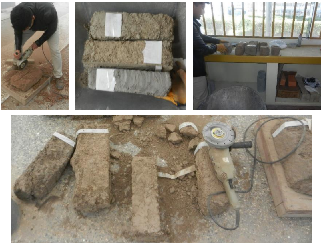
Figura 56. Corte y extracción de las muestras de Ch'ampa para el ensayo de flexión.
