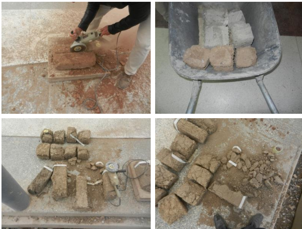
Figura 47. Identificación y extracción de muestras para ensayo de compresión UNAP.
