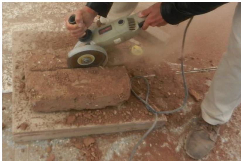
Figura 59. Corte y extracción de muestras de adobe para el ensayo de flexión.
