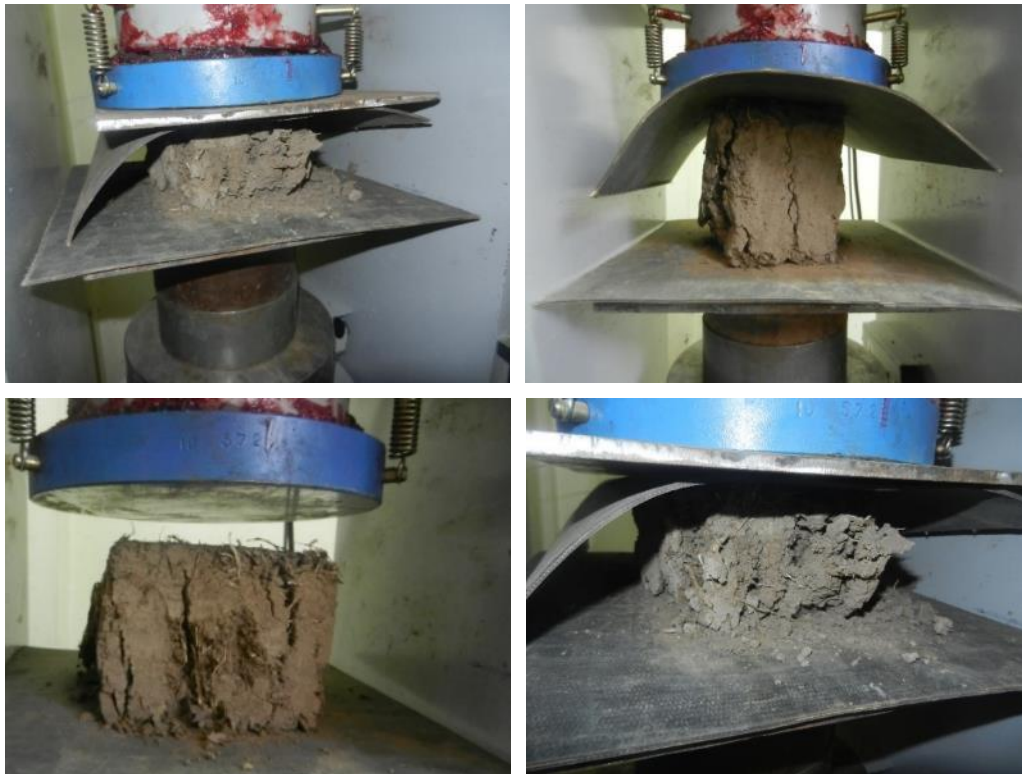
Figura 48. Ensayos a compresión de muestras de Ch'ampa UNAP. Fuente: Ensayos en el laboratorio de construcciones de la EPIC-UNAP.
