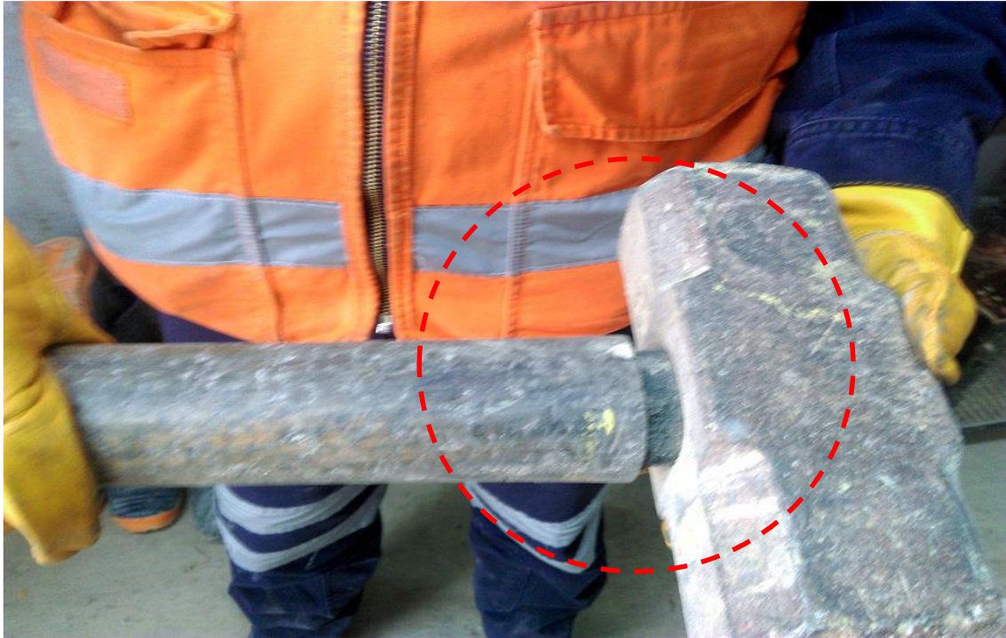
Figura 4.15: Herramienta de poder siendo usado en mal estado por parte de Confipetrol. Fuente: Mina San Rafael - Minsur S.A.
