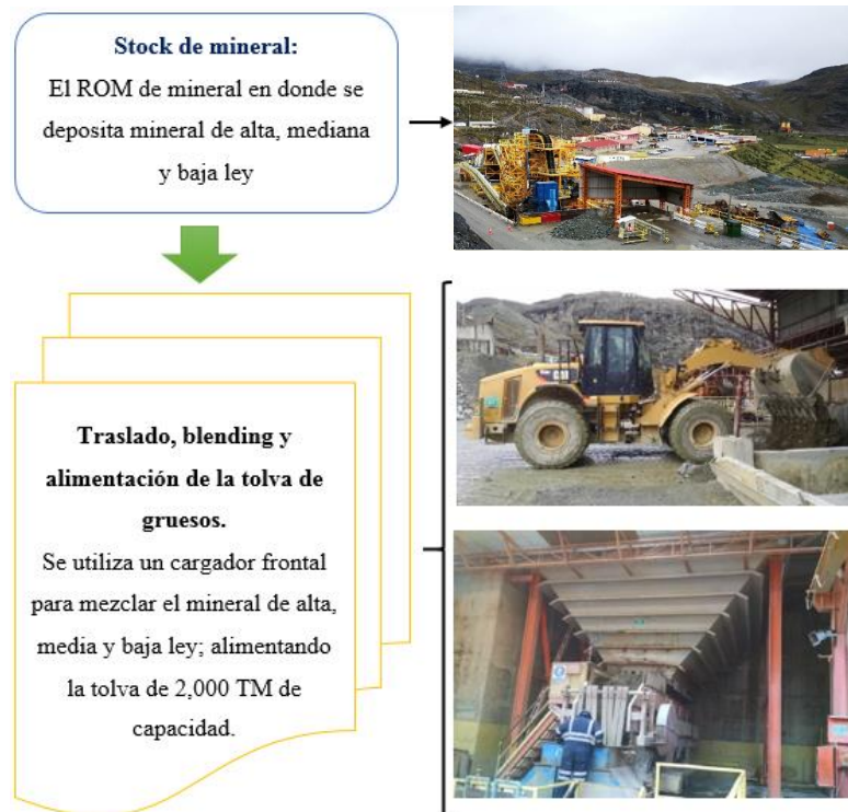
Figura 4.2: Vista esquemática de la etapa 1 del procesamiento. Fuente: (Cjanahui, 2017).
