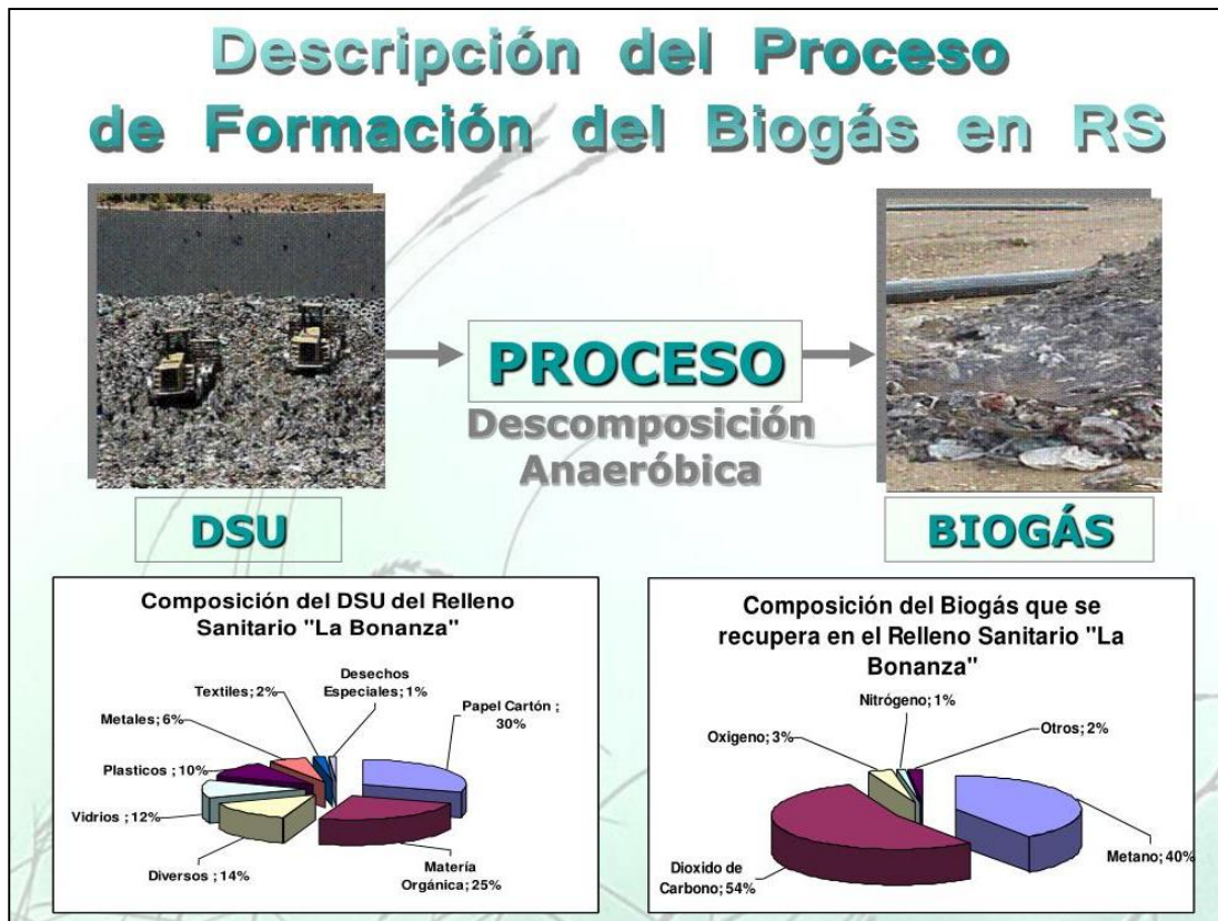
Figura 7: Formación de Biogás
