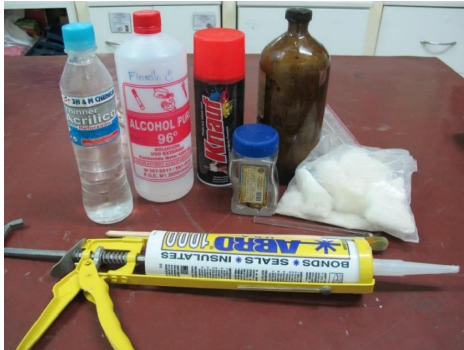
Figura N°3. 6. Materiales utilizados en la elaboración de moldes de ammonites.
