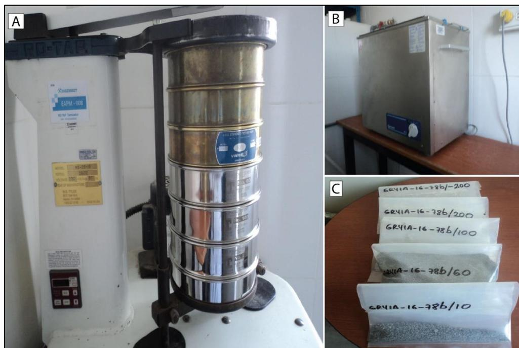
Figura 29. En A. Tamizado de las mallas N° 10, 60, 100, 200,  $<200$ , usando el “Ro-tap” En B. Limpiador ultrasónico para la limpieza de los tamices En C. Muestras debidamente codificada. Laboratorio de Preparación mecánica, INGEMMET.
