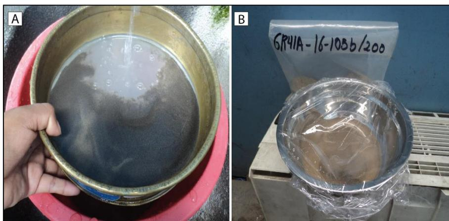
Figura 30. Lavado de sedimentos En A. Se lava la fracción 150-75  $\mu\text{m}$  (Malla N° 200). En B. Muestra Lavada debidamente, lista para ser bañada en ácido acético Laboratorio de Preparación mecánica, INGEMMET.
