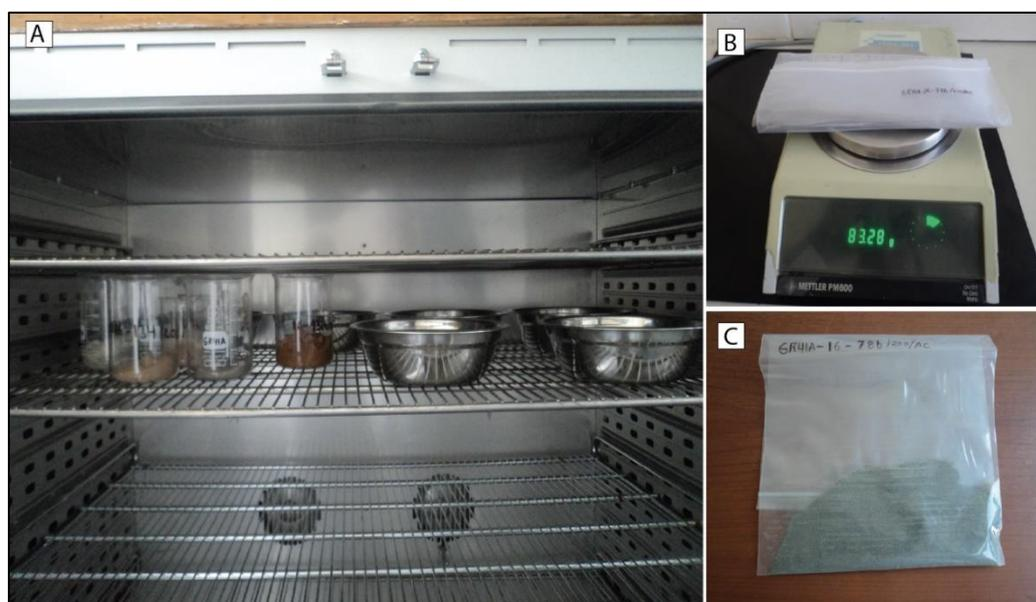
Figura 32. En A: Secado de las muestras en la estufa eléctrica a una temperatura entre 40 – 50° C. En B. Pesado de la muestra seca, después de haber sido bañado en ácido acético. En C. Muestra seca y codificada lista para ser separada (usando líquido pesado). Laboratorio de Química Analítica, INGEMMET.
