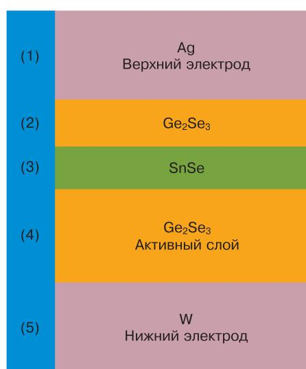
Рис. 1. Последовательность слоев и их функциональное назначение в СФК-мемристоре  $\text{Ag}/\text{SnSe}/\text{Ge}_2\text{Se}_3/\text{W}$ : активный серебряный электрод (1), спейсер (2), источник ионов  $\text{Sn}^{2+}$  (3), твердый электролит  $\text{Ge}_2\text{Se}_3$  (активный слой) (4), инертный вольфрамовый электрод (5). Межэлектродное пространство составляет 15 нм
