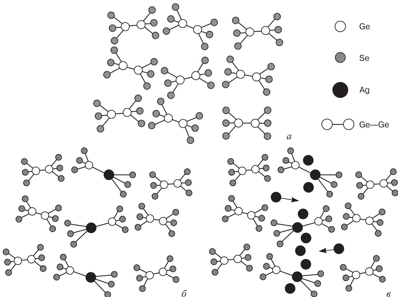
Рис. 2. Схематическое изображение начальных стадий процесса агломерации ионов  $\text{Ag}^+$  в аморфной матрице  $\text{Ge}_2\text{Se}_3$ :
