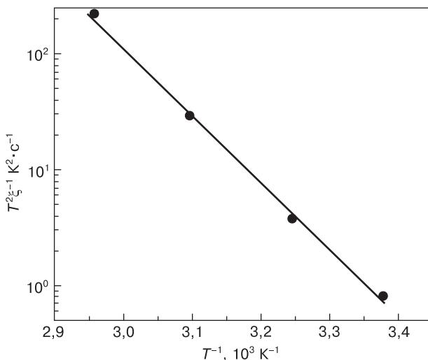
Рис. 7. Закон Аррениуса для процесса деградации СФК-мемристора Ag/SnSe/Ge<sub>2</sub>Se<sub>3</sub>/W
