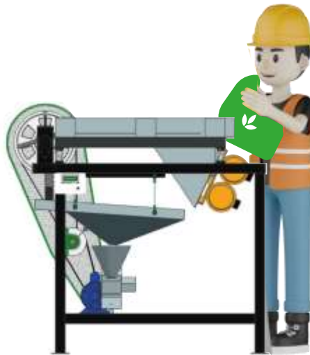
Ilustración 14-4: Forma adecuada de depositar la arveja tierna.
