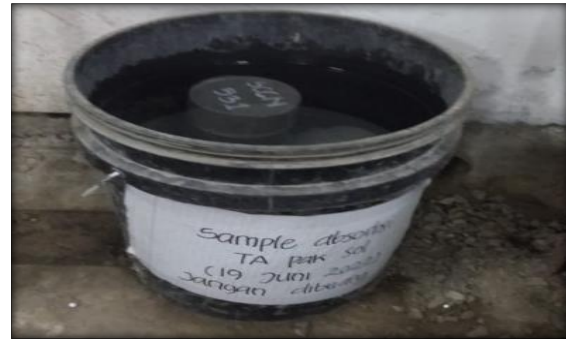
Gambar 6. Pengujian Absorpsi Beton
