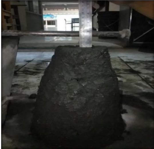
Gambar 3. Pengujian Slump Beton
