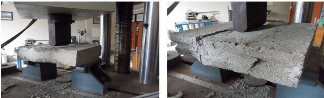
Gambar 5. Metode pengujian kuat lentur dinding batako
