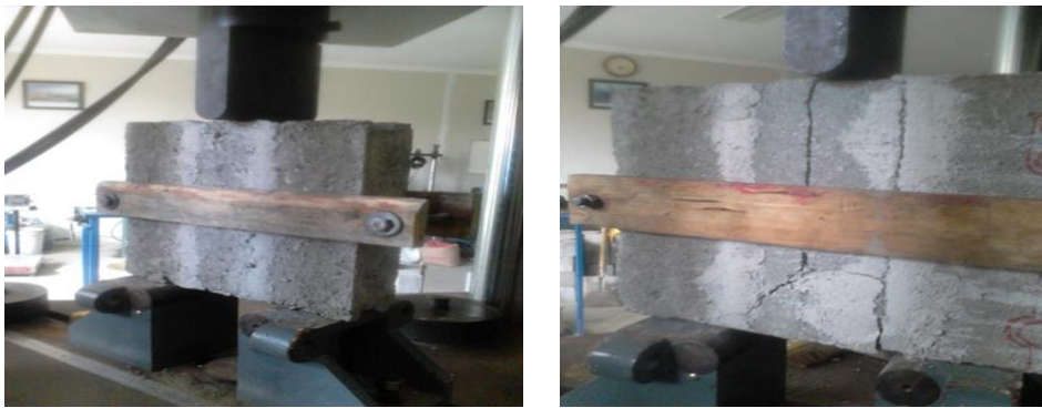
Gambar 7. Metode pengujian kuat geser dinding batako
