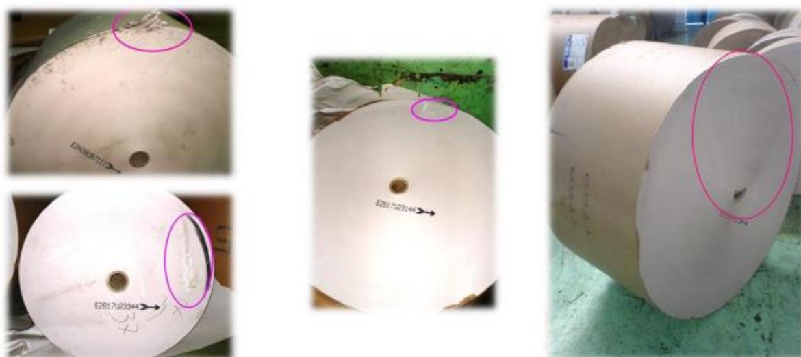
Figura 5.1. Fotos de bobinas dañadas
