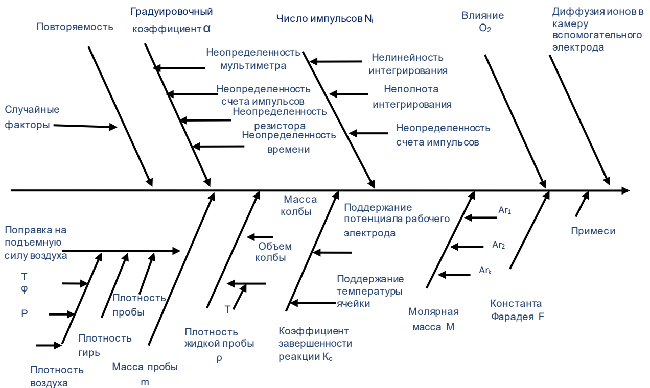
Рис. 2. Источники неопределенности воспроизведения единицы массовой концентрации висмута в растворах нитрата висмута (III) [20]
