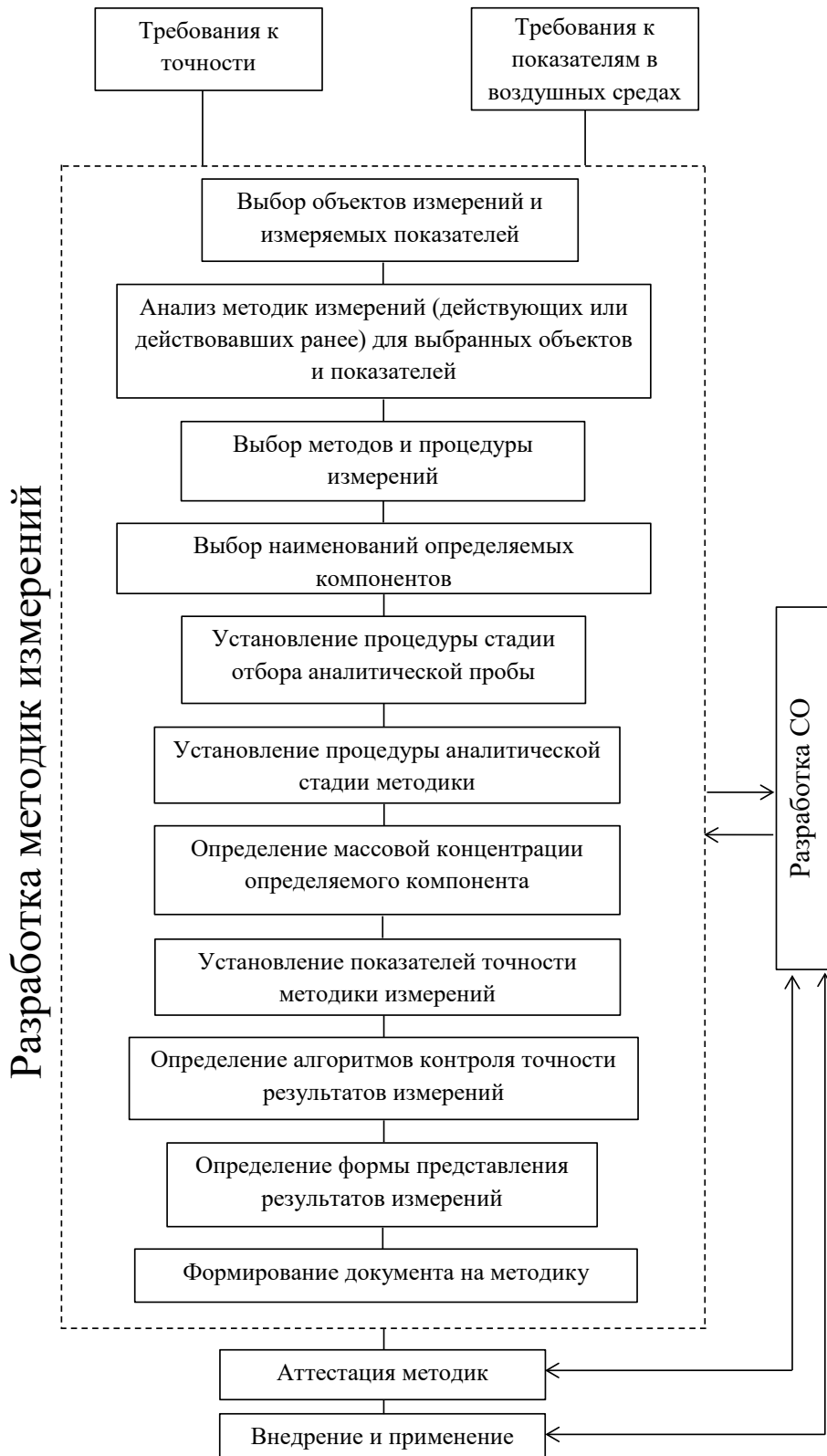
Рис. 1. Структурная схема разработки методик измерений состава воздушных сред Fig. 1. A structural scheme of development of measurement techniques for air environment composition
