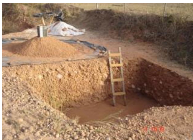
FOTO 1. Lavra manual do cascalho diamantífero, verificada no setor de cabeceira do córrego Pau Grosso. Observar o estoque do material mineralizado, já beneficiado e pronto para a lavagem.
