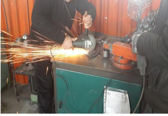
Fotoğraf 1. Büküm makinesine uygun kalıp yapımı (P044)
