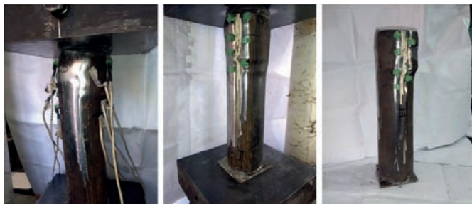
Рис. 3. Характер разрушения образцов ТБ. Фото сделано авторами статьи во время эксперимента
