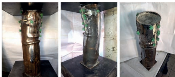
Рис. 4. Характер разрушения образцов ТБС. Фото сделано авторами статьи во время эксперимента
