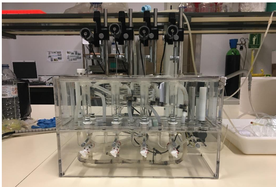
Figura 8. Sistema experimental in vitro de Banho de Órgãos. Os quatro anéis de HUA foram colocados no Banho de Órgãos que continha a solução de Krebs diluído continuamente gaseificada com carbogénio, à temperatura de 37 °C.
