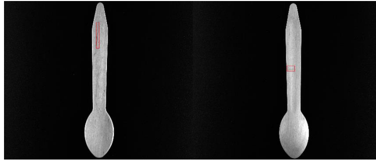
(c) kuangwuxian defect (mineral line) (d) wuran defect (pollution)
