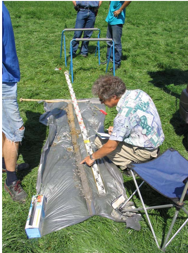
Figuur 2.4 Beschrijving van de bodemtextuur door de firma Eijkelkamp (bedrijf Spankeren)
