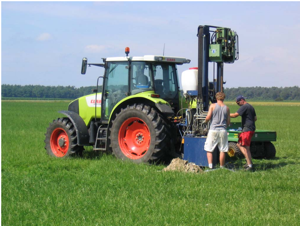
Figuur B1.1 De SonicSampDrill achterop een tractor in Nieuweroord
