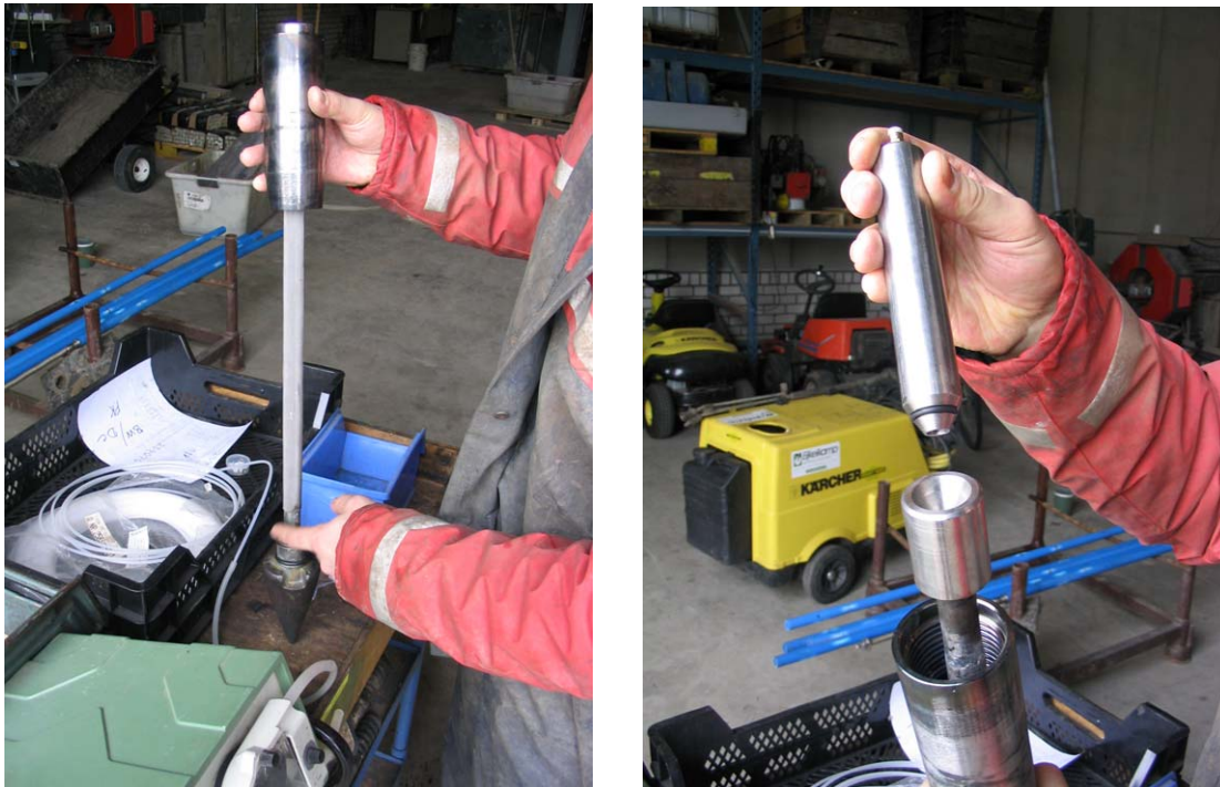
Figuur B2.3 De geopende uitschuifbare punt met filter zichtbaar (links) en het blok met conische aansluiting voor de verbinding met de slangenpomp (rechts)
