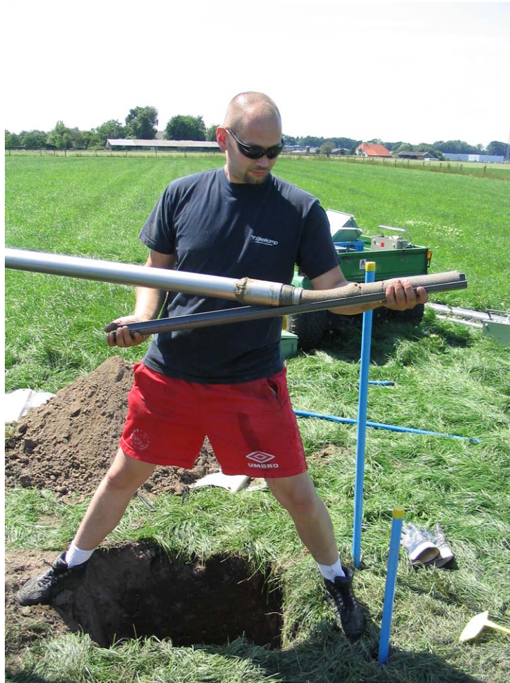
Figuur 2.1 Verzameling van grondmonsters uit de Aqualock in PVC goten te Spankeren
