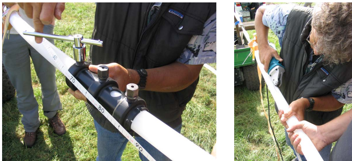
Figuur B2.4 Preparatie van de Multi-Channel Well aan maaiveld (Maarheeze); links de exacte positie bepaling, rechts het openknippen van het kanaal
