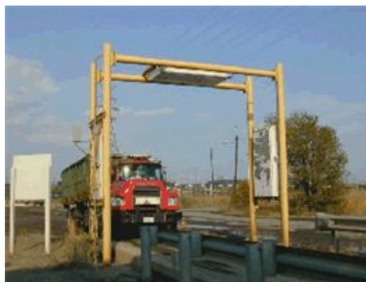
Figuur 2 Meetpoort voor detectie van radioactief materiaal. Bron: FANC.
