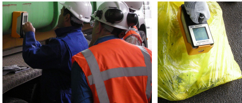
Figuur 1 Stralingsmeting aan het oppervlak van een container en een zak met afval.
