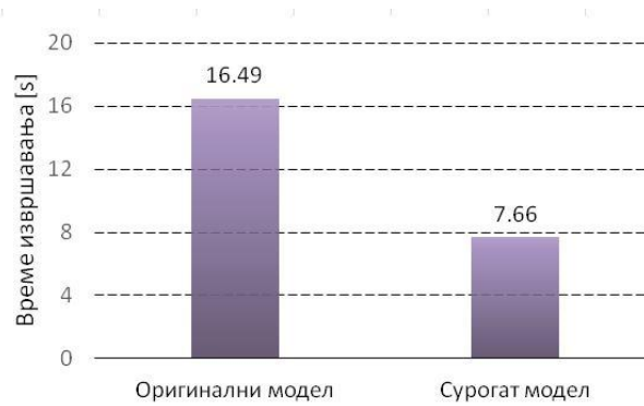
Слика 8.23 Време извршавања нумеричког експеримента изотоничне контракције са оригиналним моделом и PINN сурогат моделом
