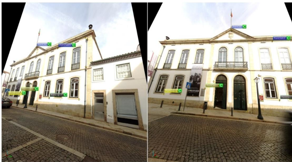
Figura 24: Identificação de pontos e planos em comum entre as imagens capturadas pelo Scanner
