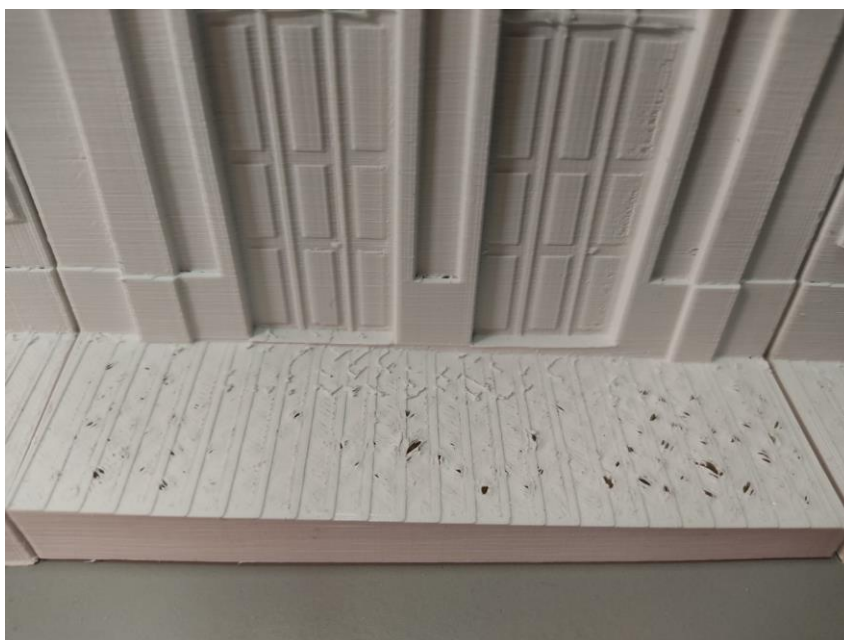
Figura 35: Peça com imperfeição que necessita de lixamento
