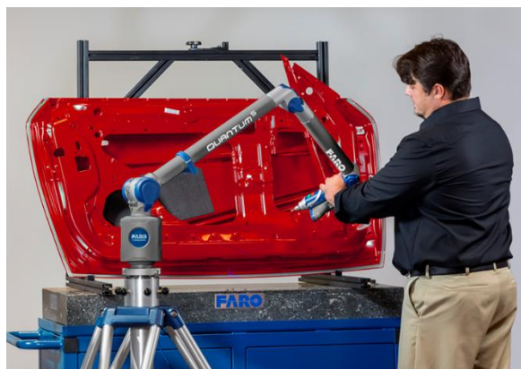
Figura 6: Scanner de contato da Faro capturando dados tridimensionais de um objeto [50]
