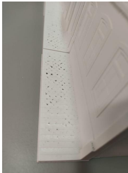
Figura 46: Sequência de falhas nas peças impressas na impressora Anycub
