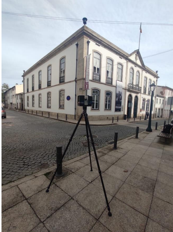
Figura 20: Scanner FARO Focus S digitalizando o Centro de Fotografia Georges Dussaud e o Auditório Paulo Quintela
