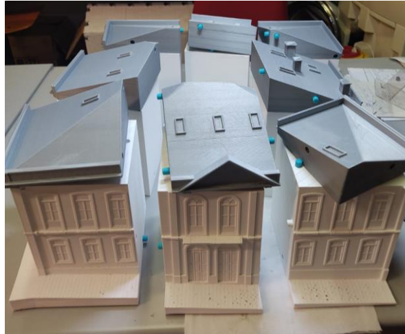
Figura 36: Pinos de junção em azul sendo colados
