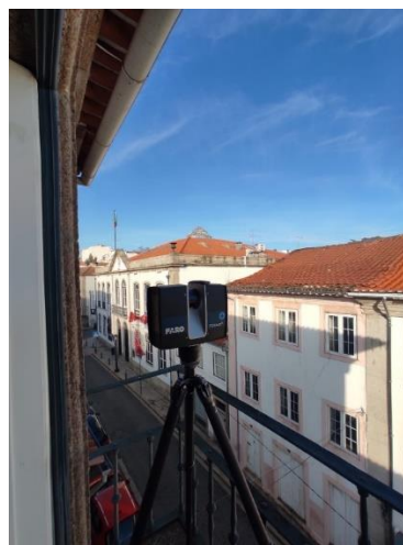
Figura 22: Scanner FARO Focus S apoiado em sacada do edifício vizinho
