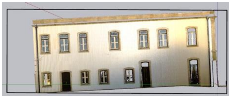
Figura 39: Nuvem de pontos da face a ser modelada no SketchUp
