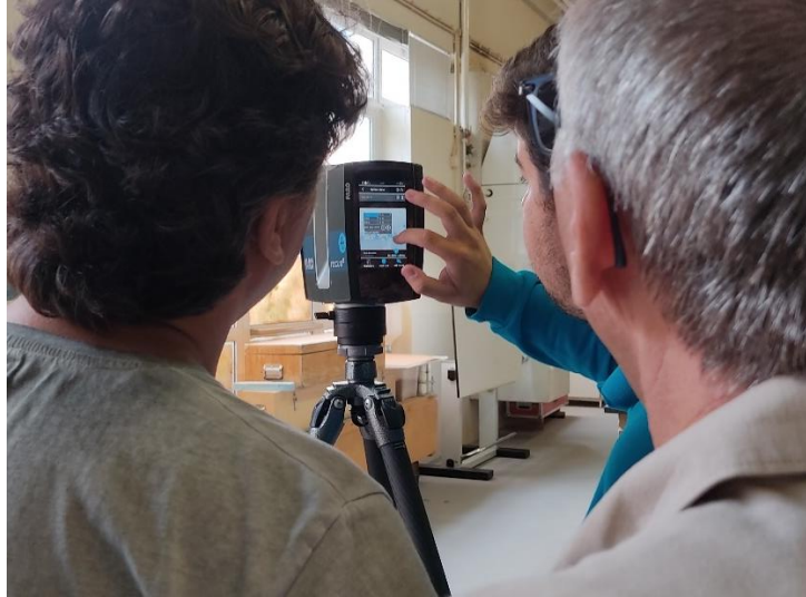
Figura 19: Apresentação da interface do Scanner FARO Focus S
