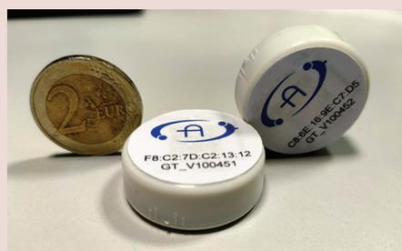
parametri utili, come l'intervallo di emissione del segnale dei Beacon Tag (impostando un'emissione ogni 5 minuti, la batteria di ogni Tag durerà circa 10 anni), le informazioni in esso contenute, il nome o la posizione dei Gateway, ecc.
