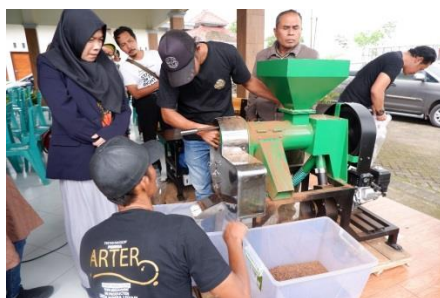
Gambar 12. Mesin Sortasi dan Pemecah Kulit Kering Kopi serta Penggunaannya
