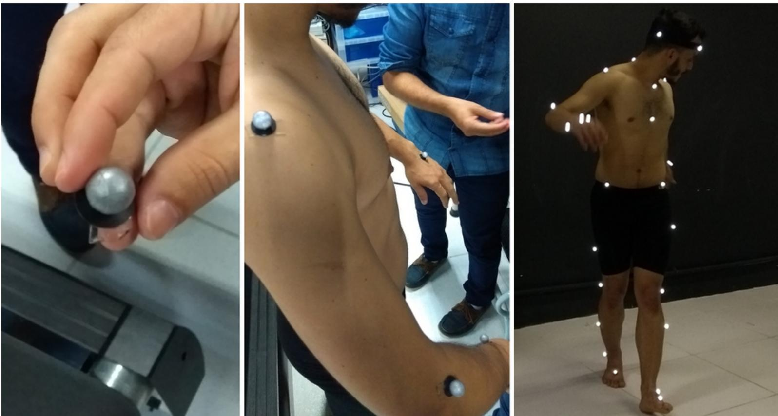
**Figura 98.** Marcadores acoplados em traje de tecido (mocap suit) para sessão de motion capture com o sistema Vicon.
