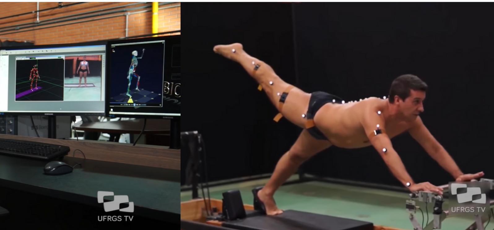
**Figura 9.** Sistema de *motion capture* *Vicon* sendo aplicado no Laboratório de Biodinâmica. ESEFID UFRGS. Fonte: Arquivo pessoal do Felipe Resende / Fotografia por Alex Oliveira.
