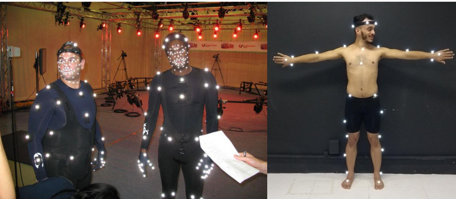
Importante observar que em ambas as imagens os marcadores estão refletindo a luz flash da câmera fotográfica. Na imagem da esquerda vemos as câmeras no nível superior, com seus LEDs infravermelhos em reação ao flash. Quanto ao quantitativo de marcadores e de segmentos articulares contemplados, que variam entre as duas imagens, pontua-se que estes dependem do objetivo do projeto, mas também do número de marcadores com que o projeto conta.
