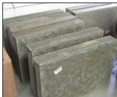
Figura 2 – Placas de concreto estrutural simples
