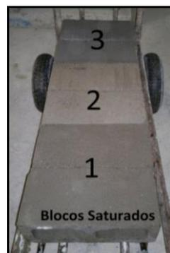
Figura 4 – Bloco de concreto saturado
