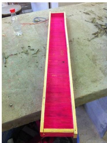
Figura 2– Fôrmas empregadas para preparo dos corpos de prova.
